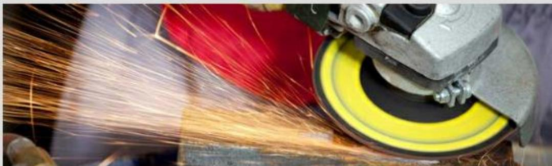
*La projection d'éclats métalliques incandescents ou de gouttes de métal fondu contre les surfaces en verre cause des dommages permanents, les particules métalliques fusionnant superficiellement avec le verre.*
