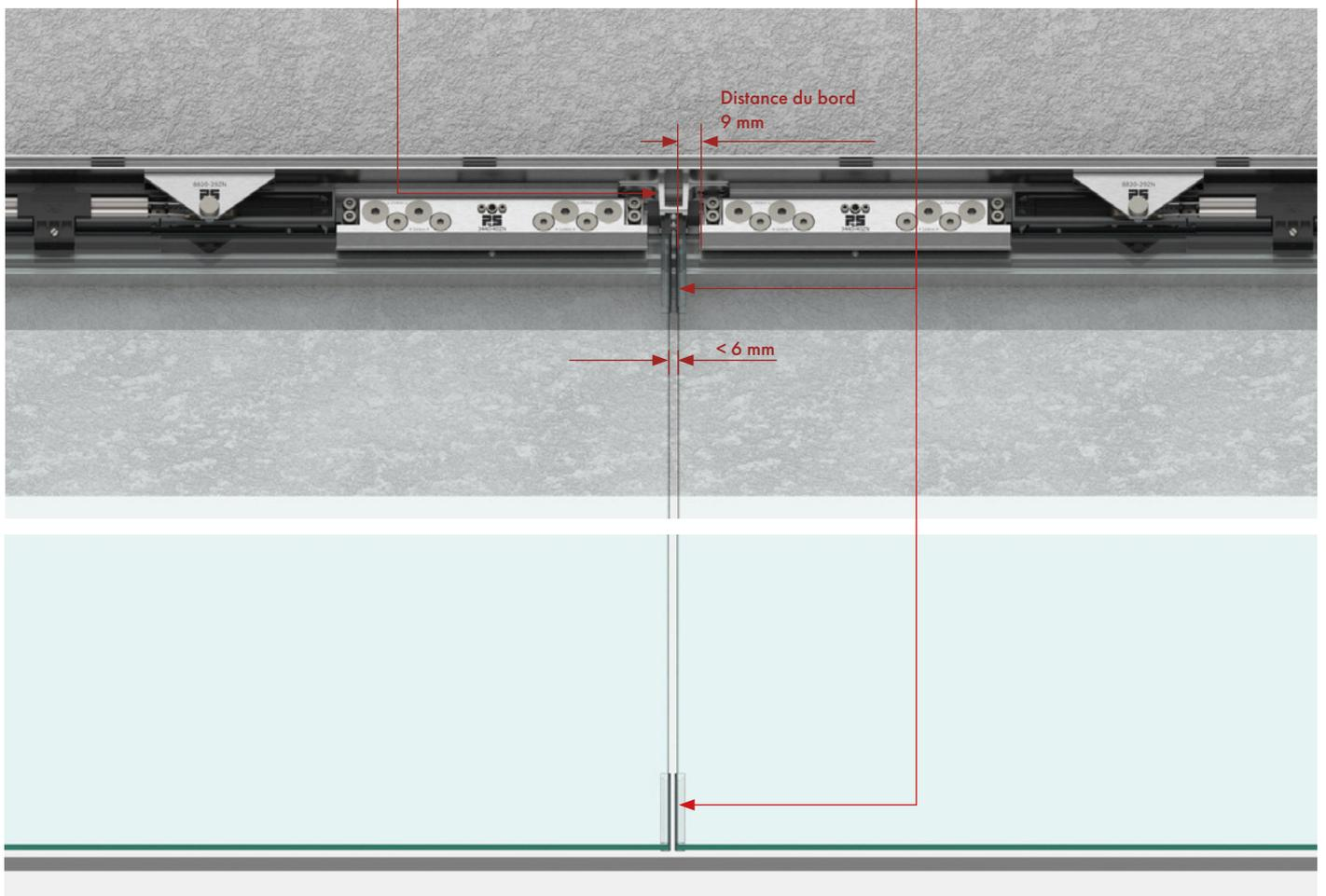
Pour les installations à deux vantaux, une distance minimale de 6 mm doit être respectée afin d'éviter toute collision de verre à verre ! Pour protéger le bord du verre, veuillez utiliser notre protection de chant : 3441KU-AS (inclus dans le kit).
