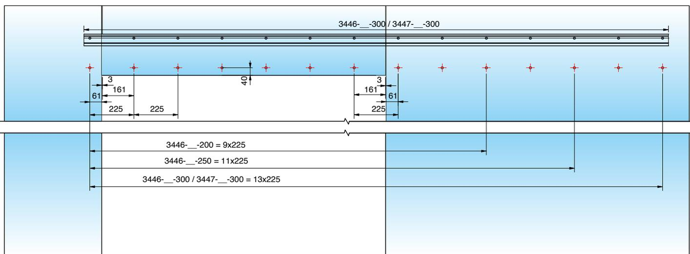
Lors du montage du verre, plusieurs supports fixent le rail de roulement au verre. Afin d'éviter tout contact entre le métal et le verre, veillez à ce que les inserts en hartzell soient correctement positionnés sur le rail de roulement et que des tuyaux en plastique soient insérés dans les trous du verre. Les inserts en hartzell et les tuyaux en plastique sont inclus dans le kit.
