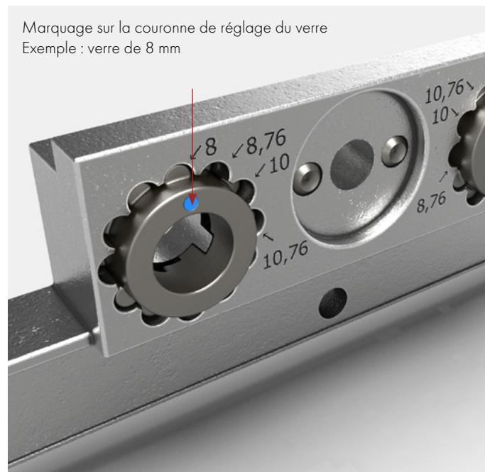
Positionner les couronnes de réglage du verre en fonction de l'épaisseur du verre. Il est possible de choisir entre quatre épaisseurs de verre différentes : 8 mm | 8,76 mm (44/2) | 10 mm | 10,76 mm (55/2)
