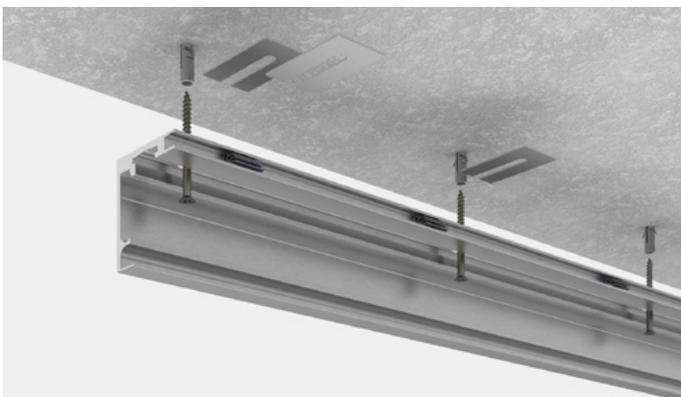
Utilisez toujours le matériel de montage approprié pour fixer le rail de roulement au mur/au plafond. Pour le montage au mur, nous proposons en option des accessoires pour les portes avec chambranle.
