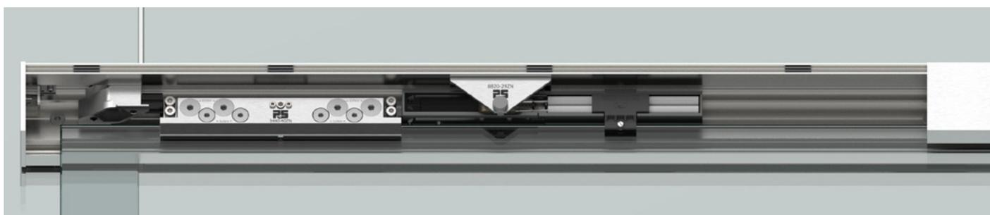
Exemple de montage du verre avec ressort détendu en position d'arrêt en douceur (position de repos)
