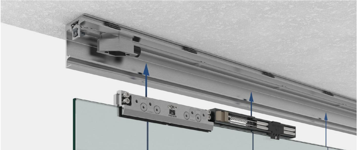
Lors de l'accrochage de la porte, il faut veiller à ce que le rail de roulement et les galets de roulement soient nettoyés avant l'accrochage. Après avoir aligné la porte en réglant les excentriques, il faut encore bloquer les chariots.
