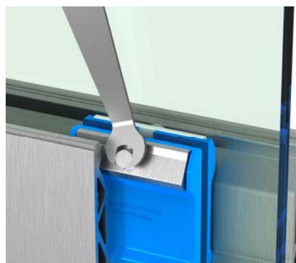
7 – Utiliser la clé pour deviser les vis sur les éléments presseurs au fin d'effectuer le réglage de l'inclinaison du panneau en verre
