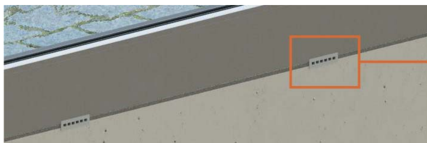
Figure 20 – Drainage - profil d'évacuation d'eau DFA 72 – installation sur dalle
